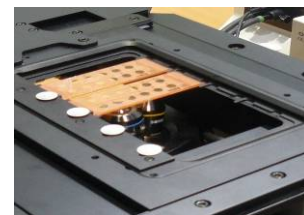
Abb. 04: Probentisch des AKLIDES® Systems
