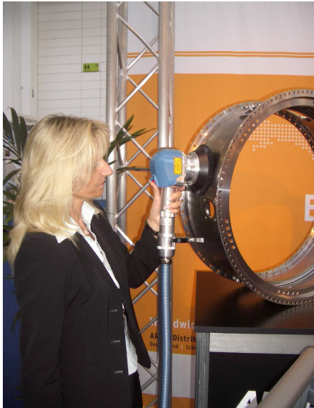
Handgeführte Laserbeschriftung eines Flugzeug-Turbinenteils
